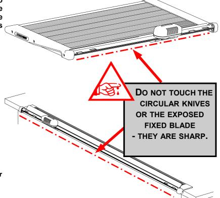
IT IS ESSENTIAL THAT THE TABLE OR WORK BENCH SURFACE ON WHICH THE CUTTER IS INSTALLED IS **FLAT**. IF THE SURFACE IS BOWED IT CAN AFFECT THE STRAIGHTNESS OF THE BLUE PLASTIC CLAMP STRIP. ENSURE BEFORE USE THE CLAMP STRIP IS CLEAR OF THE CUTTING LINE.
