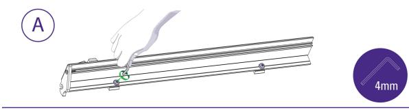
Rimuovi il fermo di misura della macchina.
