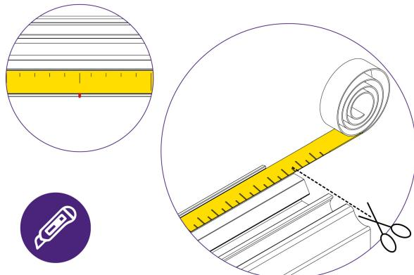
Applica la riga alla striscia d'acciaio in modo che la misura riportata sulla striscia si allinei al segno della matita. Taglia con cura il nastro in eccesso alle due estremità della striscia d'acciaio.
