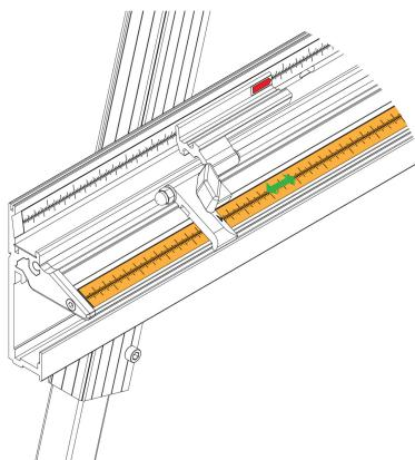
Riposiziona il fermo di misura e il tappo terminale. Le regolazioni di precisione possono essere effettuate facendo scorrere la striscia di misura in acciaio. Ripeti il procedimento sul lato destro.
