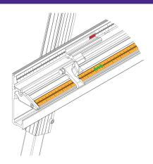
Riposiziona il fermo di misura e il tappo terminale. Le regolazioni di precisione possono essere effettuate facendo scorrere la striscia di misura in acciaio. Ripeti il procedimento sul lato destro.
