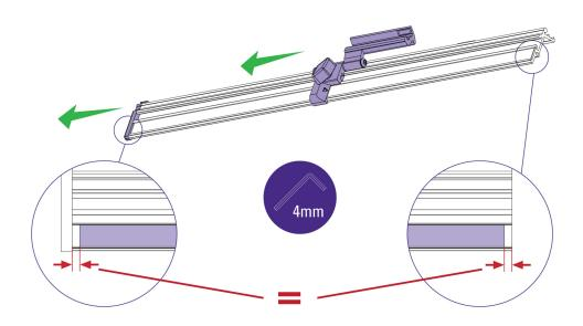
Rimuovi il tappo terminale con la chiave a brugola da 4 mm. Rimuovi il fermo di misura. Controlla che la striscia di acciaio per il nastro di misura sia centrata per la sua intera lunghezza.
