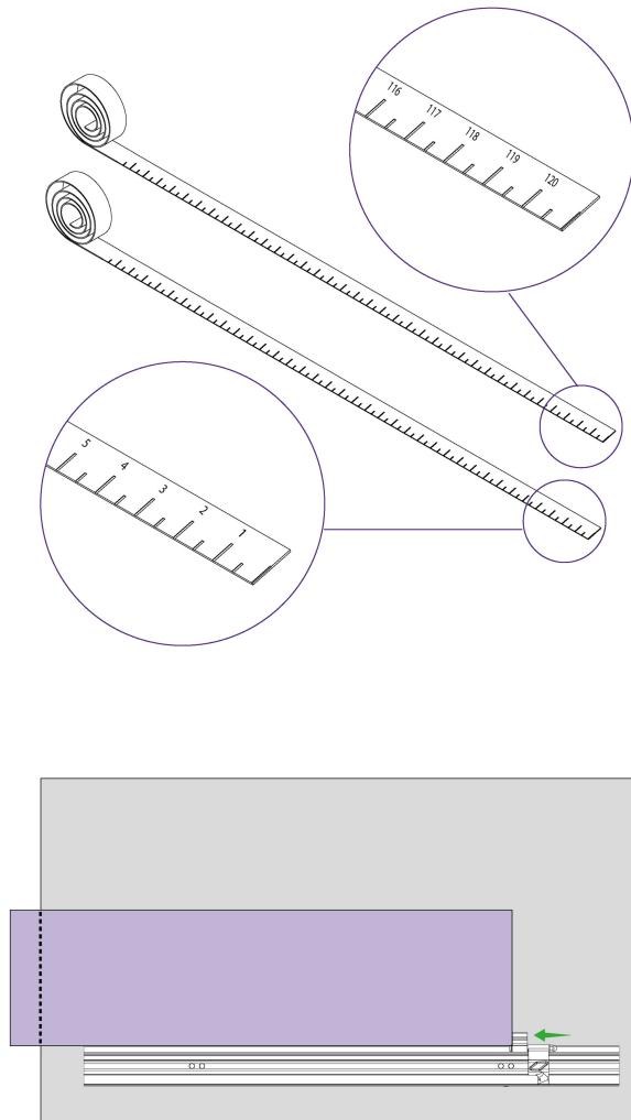
L'échelle de mesure autocollante se fixe sur une bande en acier inoxydable qui peut être glissée pour effectuer de légers calibrages une fois en place. Assurez-vous que la bande est centrée avant de continuer.
