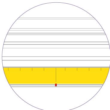
Selectionnez l'échelle de mesure et retirez environ 15 cm (6") du papier de protection à une extrémité. Placez la dimension mesurée sur l'échelle à côté de la marque au crayon. Maintenez-la en place et appuyez sur l'extrémité de l'autocollant pour le coller. Décollez le reste du papier et appuyez fermement sur l'échelle pour la fixer.
