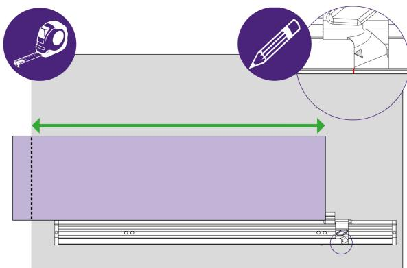
Marquez ou coupez la planche à la position « zéro ». Notez la mesure de la planche depuis la position « zéro » jusqu'au bord contre la butée de mesure. Faites une marque au crayon sur l'extrusion en aluminium comme indiqué. Retirez la butée de mesure.
