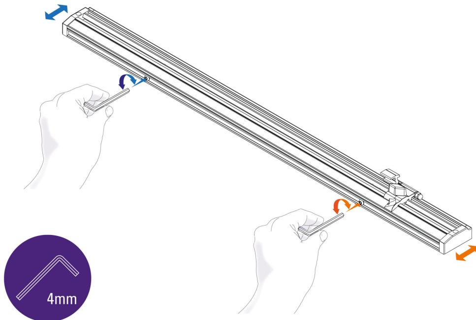
Des corrections d'équerrage peuvent être effectuées à l'aide d'une clé Allen (hexagonale) de 4 mm dans les deux vis de réglage de l'équerrage.
