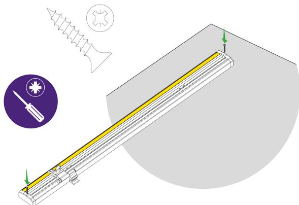
Une fois entièrement aligné, faites glisser la butée du matériau avant d'insérer les deux embouts. Utilisez les deux vis restantes pour fixer les embouts en plastique à l'aide d'un tournevis cruciforme.
