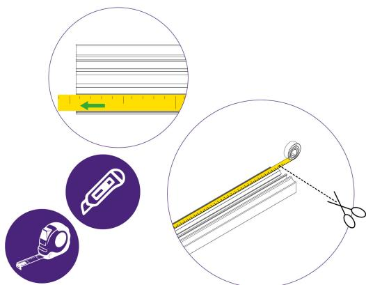
Une fois les autocollants d'échelle de mesure solidement fixés, faites glisser l'échelle de mesure hors du guide des matériaux pour accéder facilement à l'extrémité de l'échelle. Couper l'excédent à l'aide d'un cutter.
