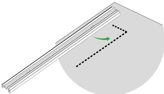
Placez le guide de matériaux dans la position souhaitée pour guider le côté gauche ou droit de la pièce (sur les dessins suivants, il est monté à droite), en vous aidant des lignes mesurées au crayon ou de ruban adhésif. S'il doit être aligné sur un autre guide/objet, utilisez une règle ou le bord d'une grande planche.
