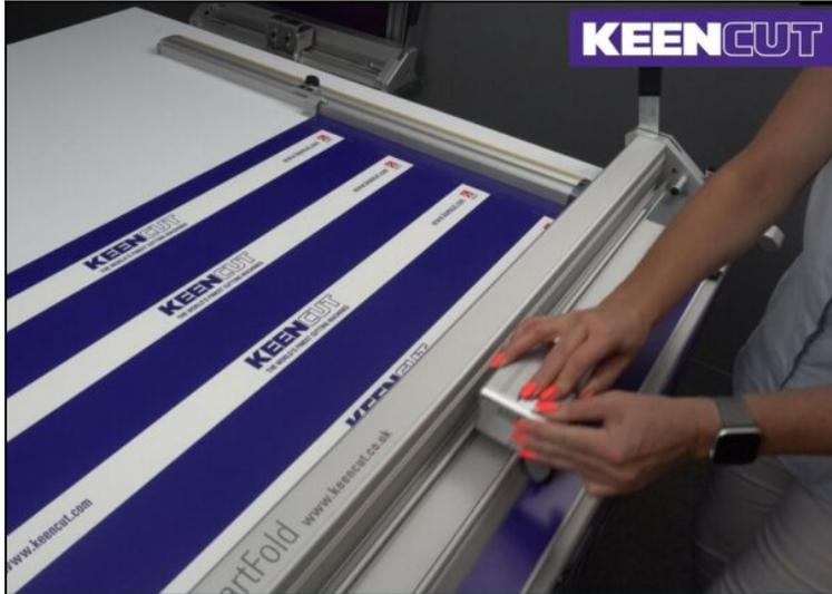
Die Keencut Materialführung lässt sich unabhängig an einer Werkbank befestigen und ist die perfekte Ergänzung zu jedem BenchTop Schneidegerät von Keencut. Sie positioniert Ihr Material präzise, indem eine exakte rechteckige Kante vor und im 90-Grad-Winkel zum Schneidegerät erzeugt wird. Die profilierte Kante führt das Material beim Eintritt in das Schneidegerät. Dies beschleunigt die Ausrichtung und garantiert einen präzisen Schnitt.
