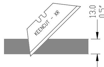
On doit tenir compte de la résilience de la carte découpée et de la profondeur maximum de coupe. Dans le cas de matériaux assez durs comme la mousse PVC, on vous recommande de ne pas dépasser une épaisseur maximum de 6 mm (0,25"); en revanche, dans le cas de matériaux plus légers, comme le carton avec une couche centrale en mousse, on peut découper une épaisseur de 13 mm (0,5") en utilisant la lame KEENCUT XR.
