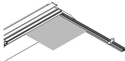
Pour fixer les échelles à la position correcte, placez un morceau de carton sur le levier de mise à l'équerre et faites glisser la butée de mesure sur le coin arrière et fixez-la en position. Découpez le carton en appuyant sur la lame et en l'entraînant régulièrement à travers le carton. Mesurez la largeur du carton, et fixez l'échelle de mesure pour qu'elle mesure la dimension au niveau de la butée.
