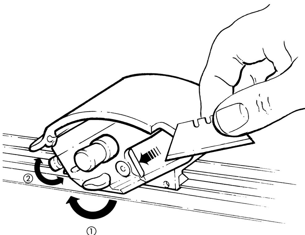
**Insertion et réglage de la lame**
