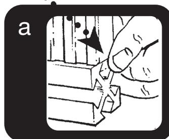
4. Colocar los tornillos de fijación en cada uno de los dos orificios grandes de la abrazadera, atornillar sólo 2 ó 3 vueltas.
